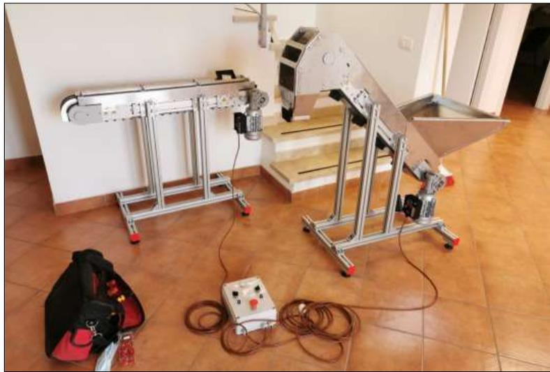
Fig. 79 – Nastri - Dry Run Test prima dell'integrazione.
