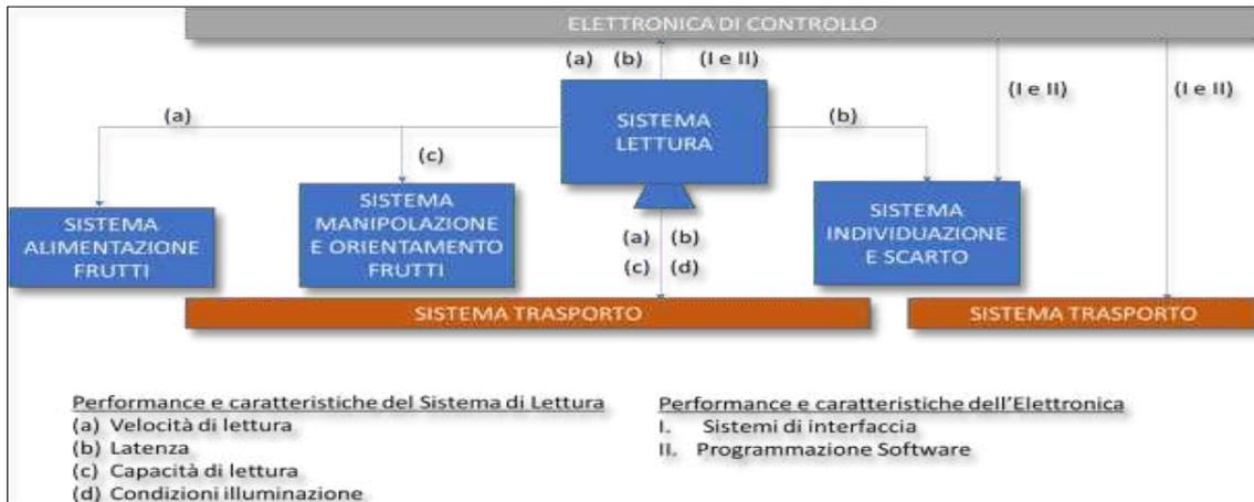
Fig. 59 – Macchina Selezionatrice - Schema "a blocchi funzionali" – Interconnessioni causali.
