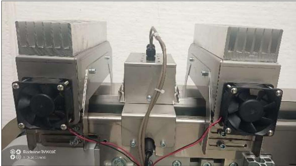
Fig. 83 – Sistema di visione/illuminazione e relativo sistema di raffreddamento.
