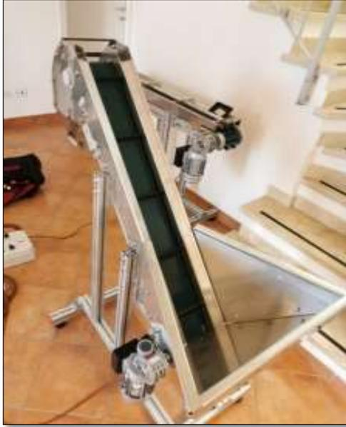
Fig. 77 – Nastro di carico.
